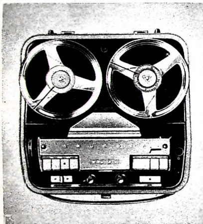
Tonbandgerät „TK 41“ mit 7-W-Gegentak-Endstufe von Grundig
